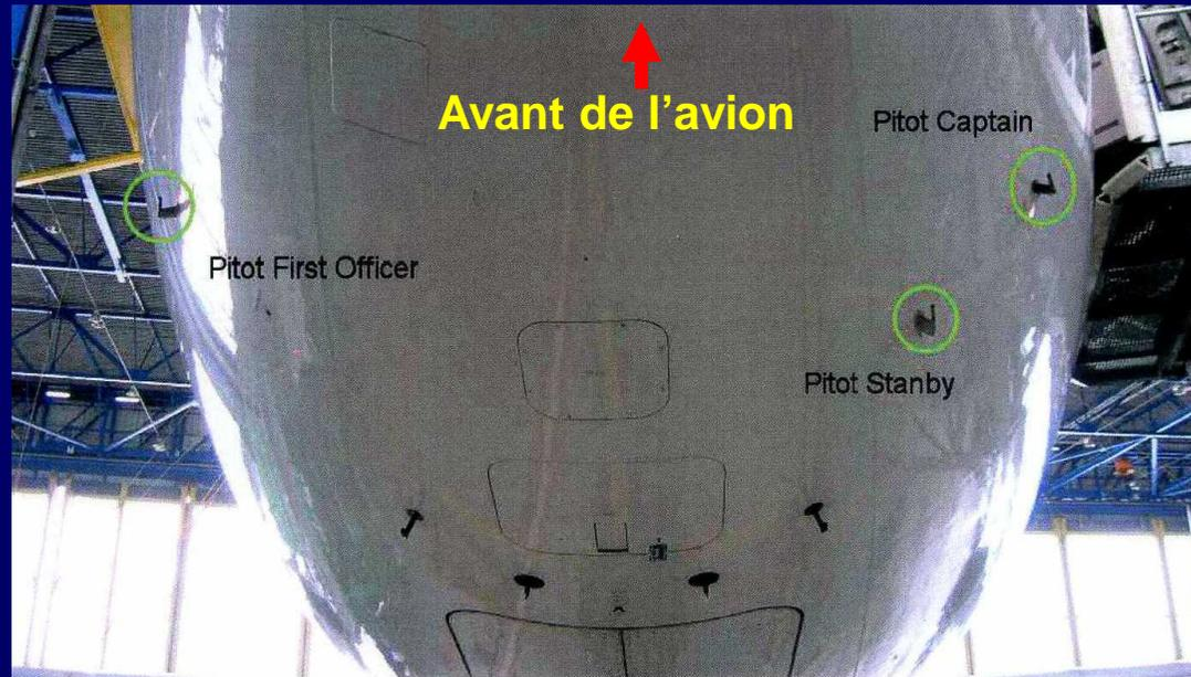
Position des sondes Pitot sur l'Airbus A330
